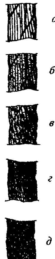
Рисунок 5. Износ наружных проволок каната крестовой свивки:
