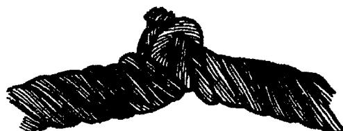
Рисунок 15. Перекручивание каната
